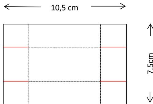
Den Kraftkarton (Box) rundherum bei 3,5cm falzen und an den roten Linien einschneiden.
